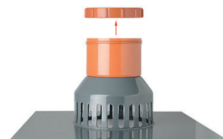
Gründachschacht: Schraubdeckel zur Sichtprüfung und Reinigung des Abflusses. Flansch aus robustem Hart-PVC
